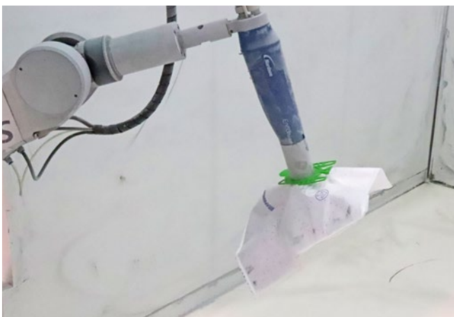
Einfach aber effektiv: Ein Staubsaugerbeutel fängt über einen bestimmten Zeitraum die ausgestoßene Pulvermenge auf, dann wird gewogen.
