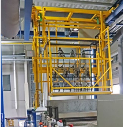
Die Bauteile werden bei Welco mit einem besonders UV-stabilem KTL-Lack beschichtet.
