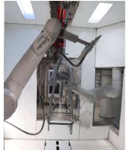
Die weiche Wolke versetzt die Roboter in die Lage, auch schwierige Zonen zu beschichten.
