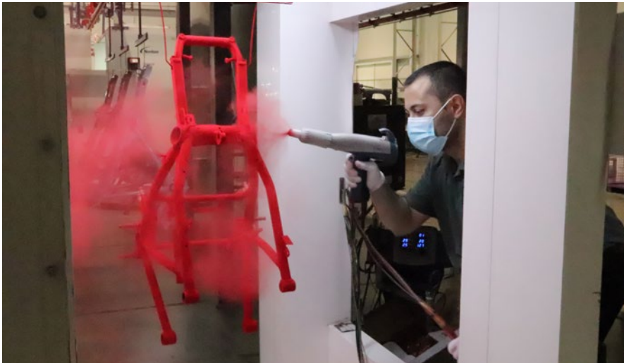
Die Dichtstrom-Technologie hat die Beschichtungsergebnisse der komplizierten Geometrien der Motorradrahmen gegenüber der früher verwendeten Injektor-Technik deutlich verbessert.
